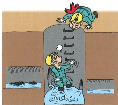
下水道工事での硫化水素中毒の例
